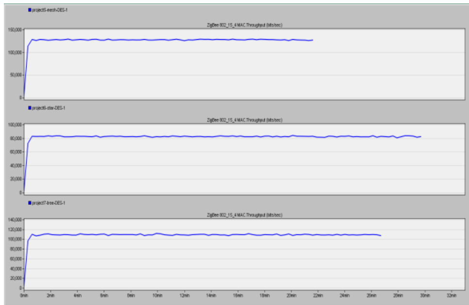
Рис. 6 – Наскрізна швидкість для ZigBee Mesh, Star та Tree топологій
