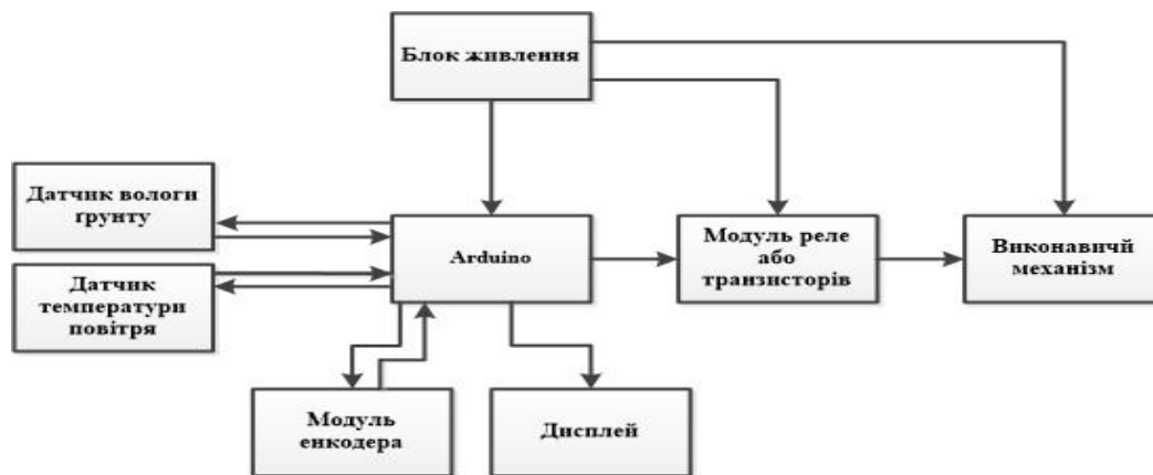
Рис.1 – Структурна схема автоматизованої системи контролю клімату і поливу теплиці
