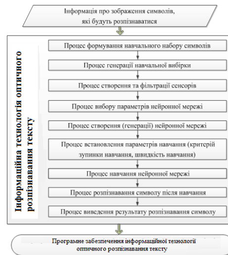
Рисунок 1 – Структура інформаційної технології оптичного розпізнавання тексту
