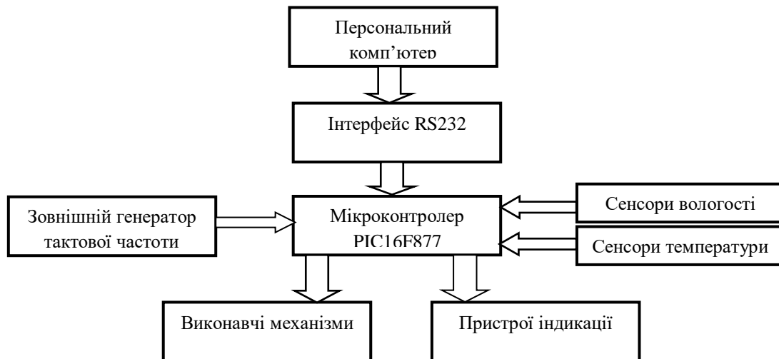
рис.1. Структурна схема системи автоматизації технологічного процесу сушіння деревини
