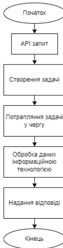
Рисунок 5 – Загальна схема алгоритму роботи інформаційної технології для виявлення HTTP запитів з аномальною поведінкою
