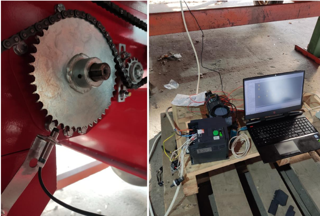
Рис. 2. Перевірка коректності роботи електропривода вальців в реальних умовах експлуатації
