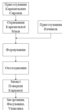
Рис. 1. Технологічна схема виробництва карамельних цукерок
