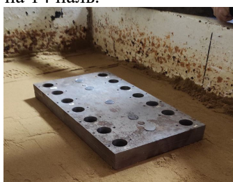
Рис. 3 – Експериментальна модель фундаменту
