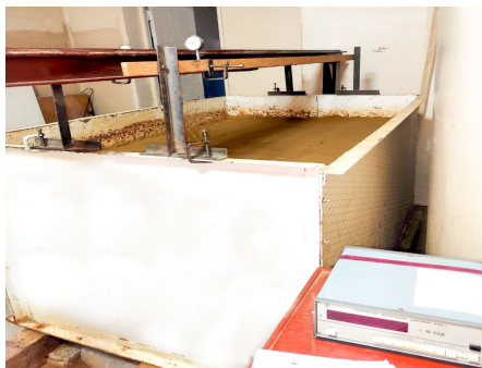
Рис. 1 – Лоток з ущільненим піском, що імітує ґрунтову основу під фундамент
