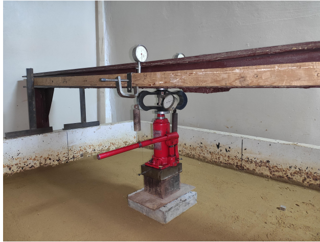
Рис. 8 – Модель випробування плити ростверку
