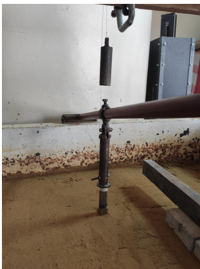
Рис. 9 – Модель випробування плити ростверку у варіанті умовного фундаменту
