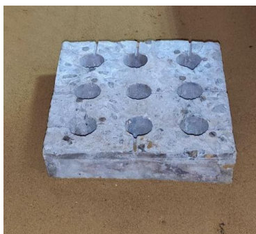
Рис. 1 – Модель ростверку 200×200 мм
