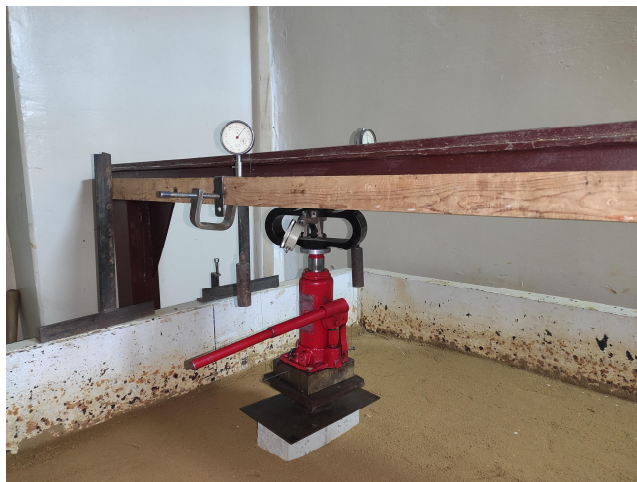
Рис. 9 – Модель випробування плити ростверку у варіанті умовного фундаменту
