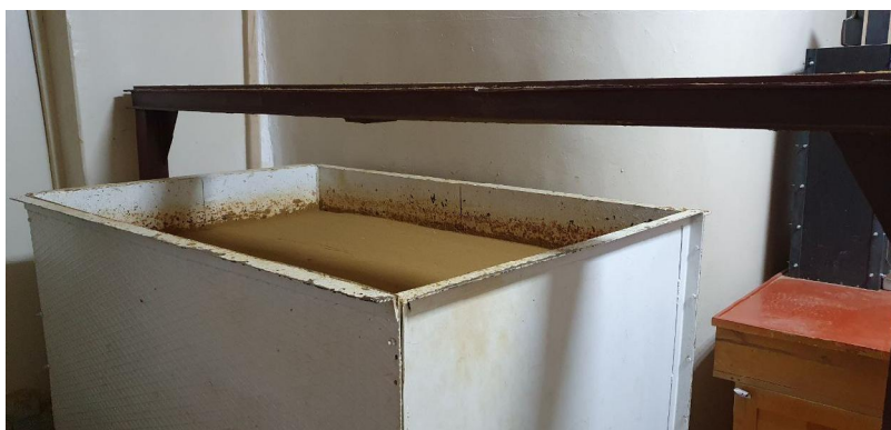
Рис. 2 - Лоток з ґрунтовою основою під фундамент
