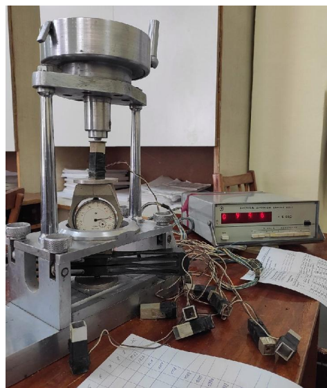
Рис. 4 – Пристрій для тарування датчиків
