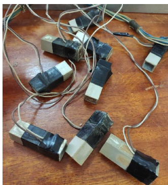
Рис. 3 – Наголовники із тензометричними датчиками
