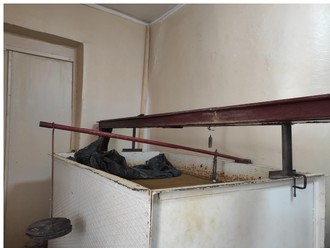
Рис. 10 – Модель випробування одиночної палі в лотку
