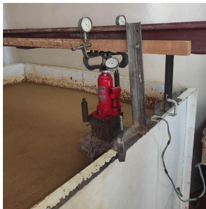
Рис. 7 – Модель пального фундаменту перед випробуванням
