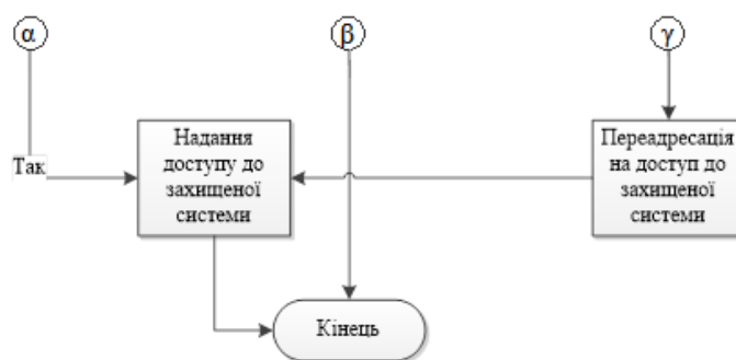
Рисунок 1. Блок-схема алгоритму роботи програмного додатку для автентифікації користувачів засобами вдосконаленої технології дактилоскопії
