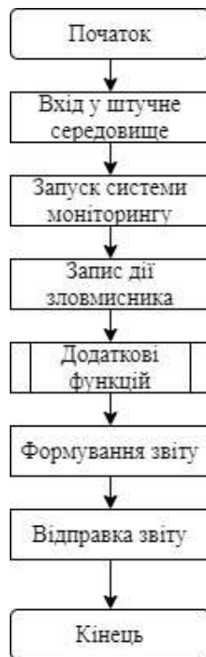
Рисунок 1 – Блок-схема роботи штучного середовища.
