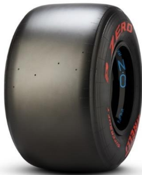
Рис. 6. Крайній варіант структури еластичного рушія з відсутністю рисунку протектора
