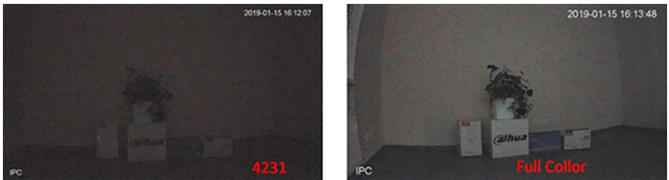
Рис. 1 – Порівняння застосування технології Full-color та звичайної HD-CVI камери.
