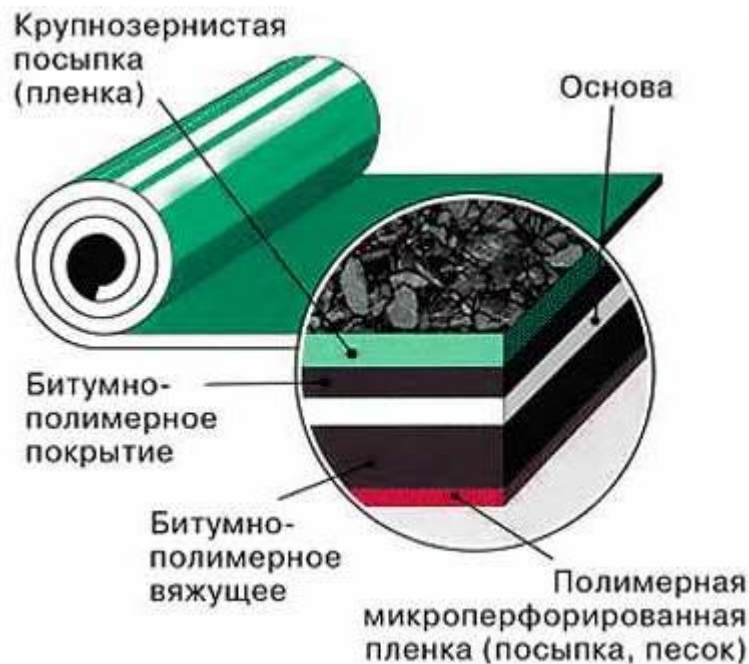
Рис.2 – Товщина і схема руберойду
