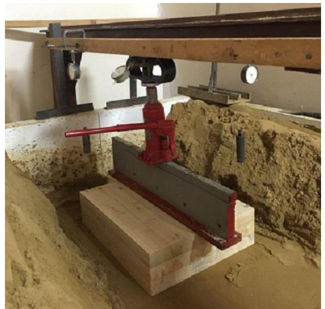
Рисунок 4 – Завантажений суцільний фундаментний блок
