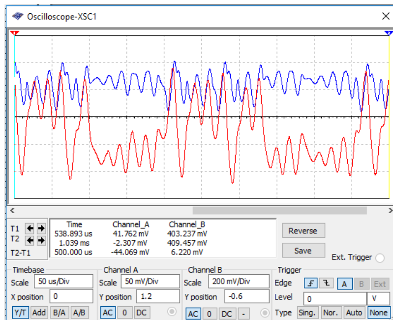
Рис. 4. Осцилограми генерованих хаотичних напруг простого безіндуктивного RC-генератор детермінованого хаосу на двох біполярних транзисторах
