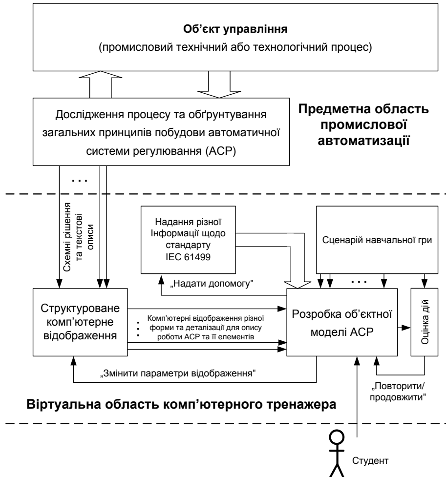
Рис. 3. Загальний принцип комп'ютерного відтворення в тренажері процесу об'єктного проектування СРТ
