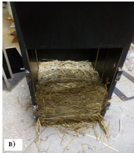
Риснок 3 - Процес пресування солом'яних тюків а) відмітка потрібної висоти тюка на корпусі установки; б) пресування з передачею зусилля через домкрат та опорну балку; в) виймання готового зразка тюка після завершення пресування
