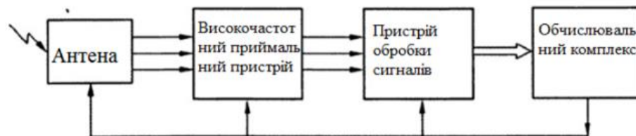
Рисунок 1 – Блок схема тракту обробки сигналів
