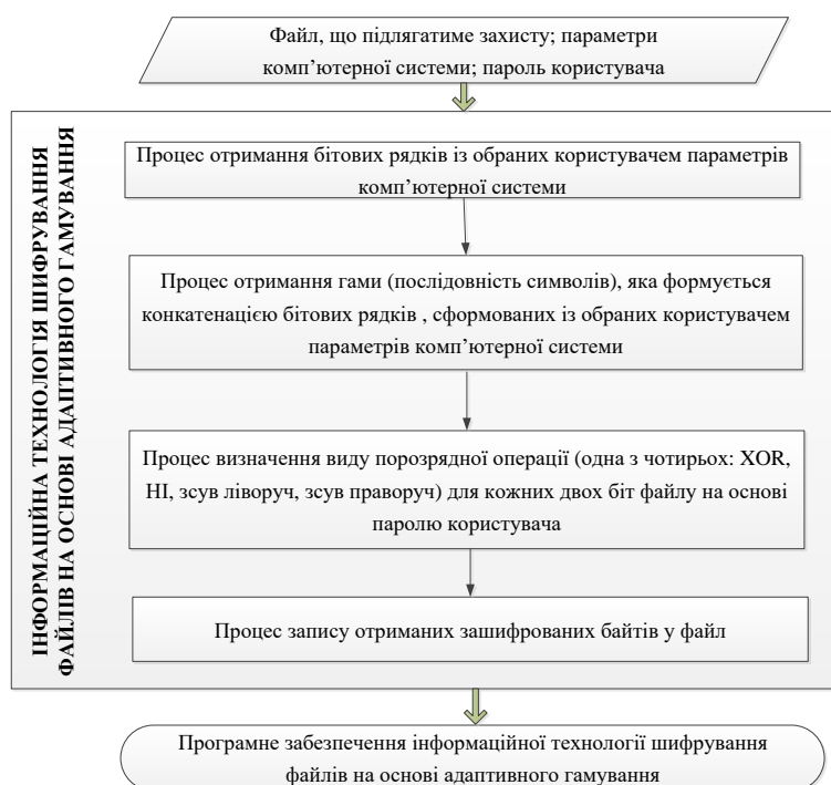
Рисунок 2 – Структура інформаційної технології шифрування файлів на основі адаптивного гамування
