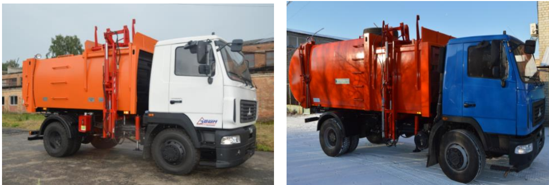
а) б) Рис. 1. Смітєвоз КО-431-03 (а) та КО 426 (б) з боковим завантаженням
