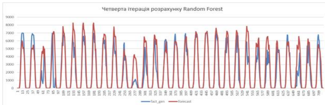
Рис. 4 - Четверта ітерація розрахунку прогнозу з використанням Random Forest, з розширенням навчальної вибірки «ФЕС-1»
