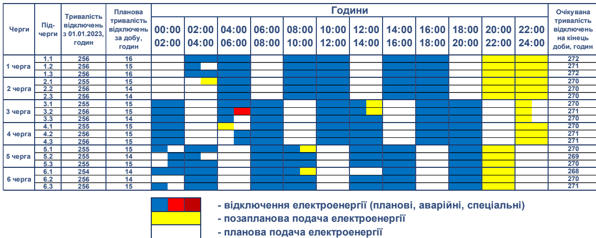
Рис. 3 – Приклад звіту про виконання графіка погодинних відключень на рівні окремого адміністративного району
