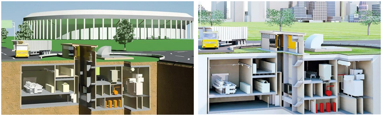
Рис. 1. Фрагмент монтажу підземної трансформаторної підстанції [6].
