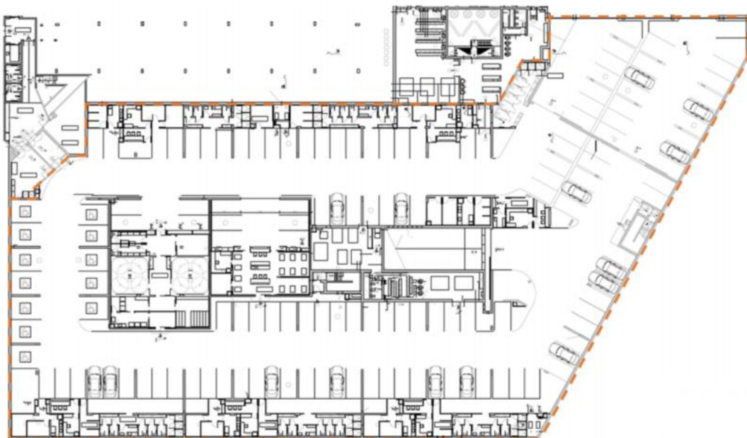
Рисунок 8. Приклад планування сховища в підземному паркінгу лікарні Sheba MC в Ізраїлі [15]
