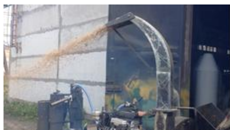
Рис. 2. Установка для виготовлення трісок в лісі. Виробничі випробування
