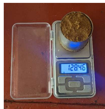
Рисунок 2 – Ваговий контроль щільності ґрунтів
