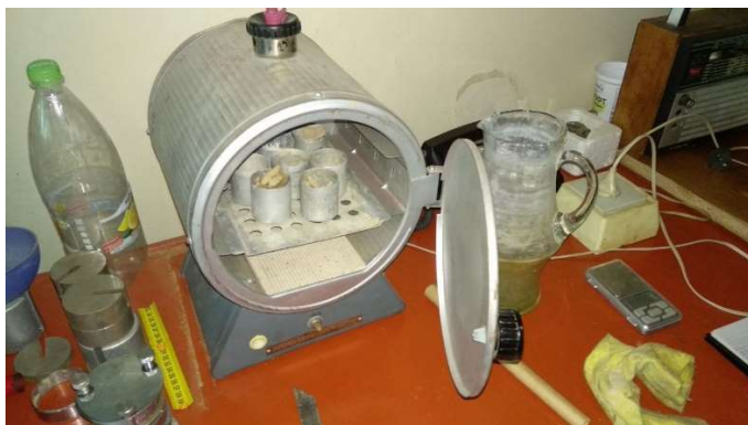
Рисунок 1 – Піч для визначення вологості ґрунтів
