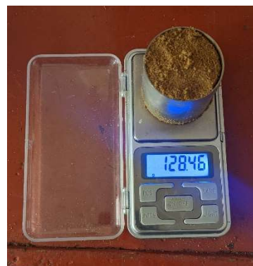
Рисунок 2 – Ваговий контроль щільності піску
