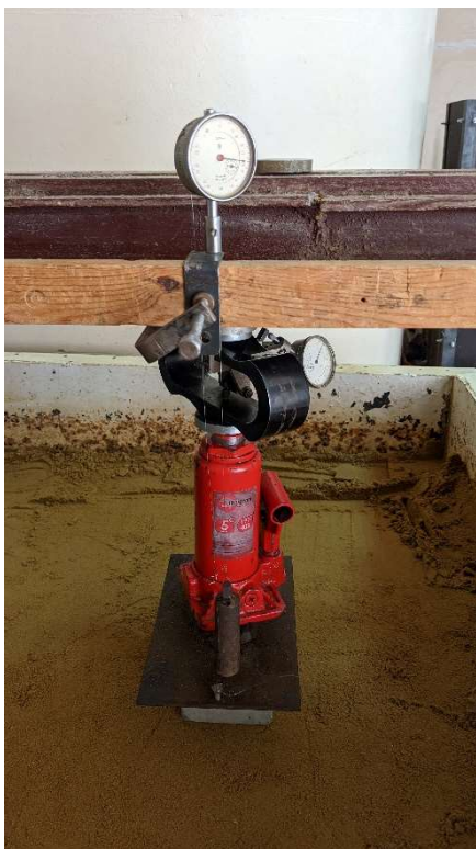
Рисунок 3 – Модель фундаменту перед випробовуванням
