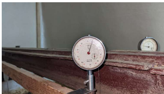
Рисунок 4 – Монтаж прогиноміру до стінок лотка
