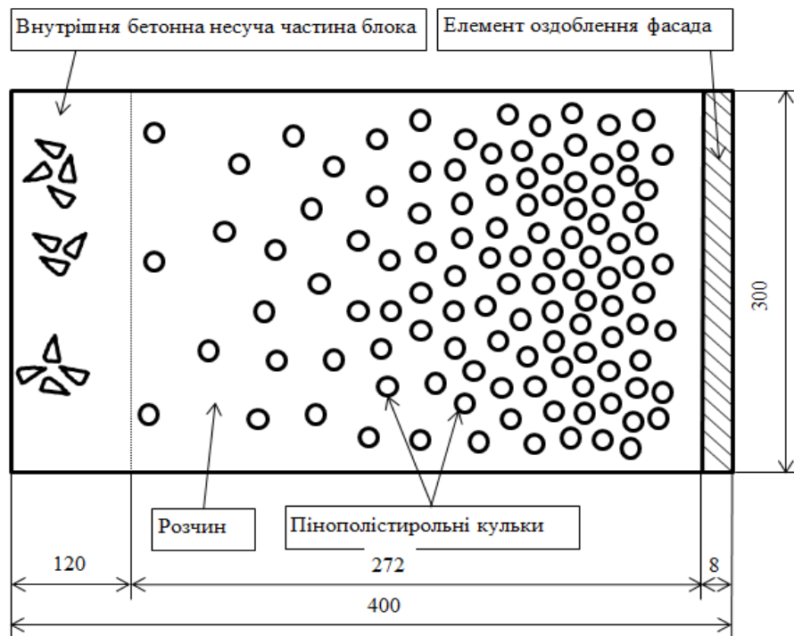
Рисунок 1 – Конструкція високотехнологічного термоблока
