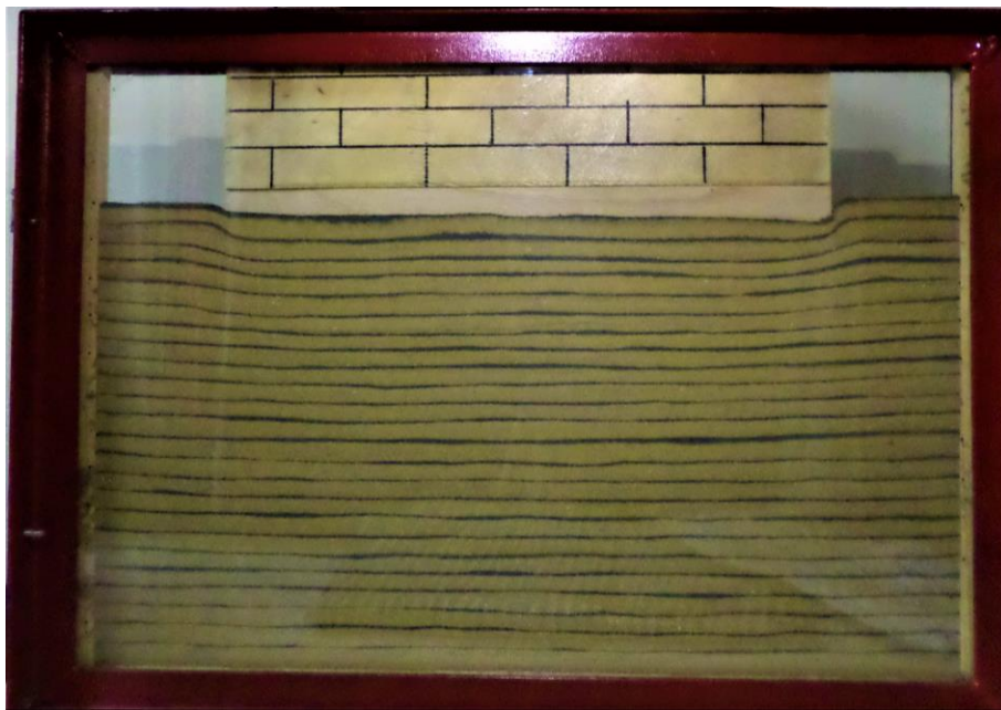
Рисунок 5 – Модель суцільного стрічкового фундаменту
