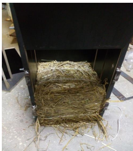
Рис. 1 Установка для пресування солом'яних тюків (зліва – відмітка потрібної висоти тюка на корпусі установки, справа – процес пресування з передачею зусилля через домкрат та опорну балку)
