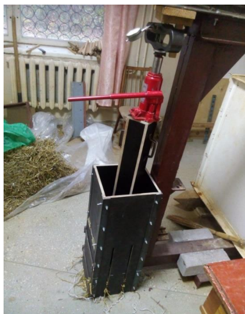
Рис. 1 Установка для пресування солом'яних тюків (зліва – відмітка потрібної висоти тюка на корпусі установки, справа – процес пресування з передачею зусилля через домкрат та опорну балку)
