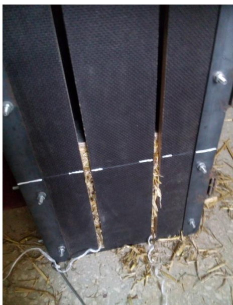
Рис. 1 Установка для пресування солом'яних тюків (зліва – відмітка потрібної висоти тюка на корпусі установки, справа – процес пресування з передачею зусилля через домкрат та опорну балку)
