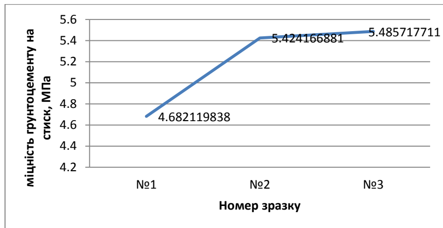
Рис. 3 – Графік міцності ґрунтоцементу на стиск із вмістом цементу 40 % та золи-виносу 60 %
