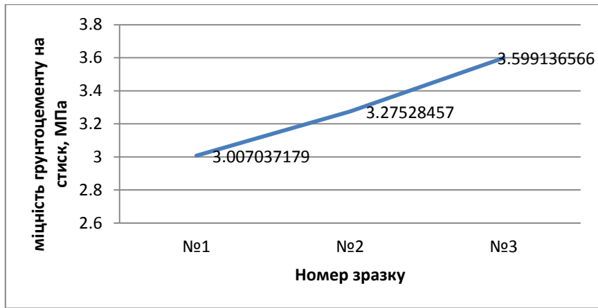
Рис. 2 – Графік міцності ґрунтоцементу на стиск із вмістом цементу 80 % та золи-виносу 20 %
