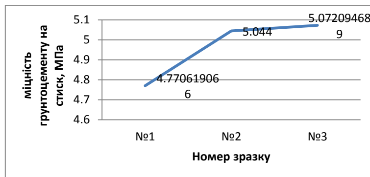
Рис. 1 – Графік міцності ґрунтоцементу на стиск із вмістом цементу 100 %
