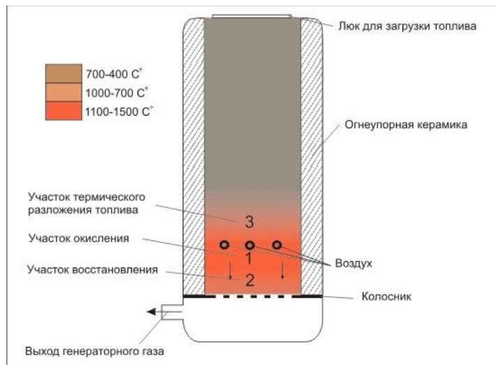
Рисунок 1 - Принципова схема газогенератора оберненої дії
