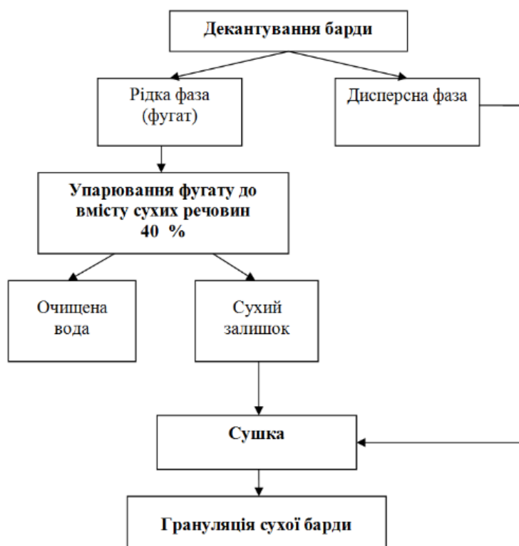
Рис. 3. Схема виготовлення сухої гранульованої барди
