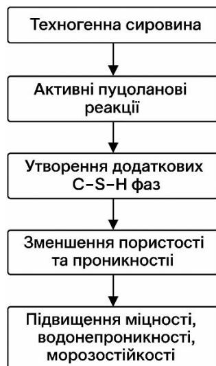
Рисунок 1 – Схема впливу техногенних матеріалів на формування структури бетону
