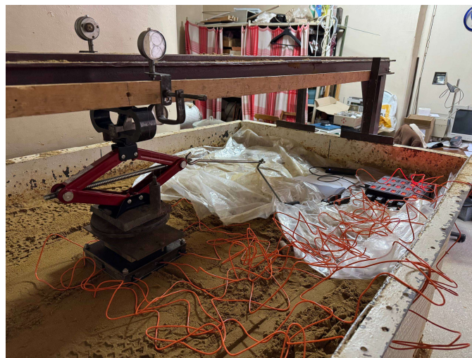
Рис. 10 – Система для передавання навантаження на модель пальового фундаменту
