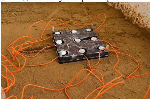
Рис. 8 – Розміщення датчиків у тілі ростверка
