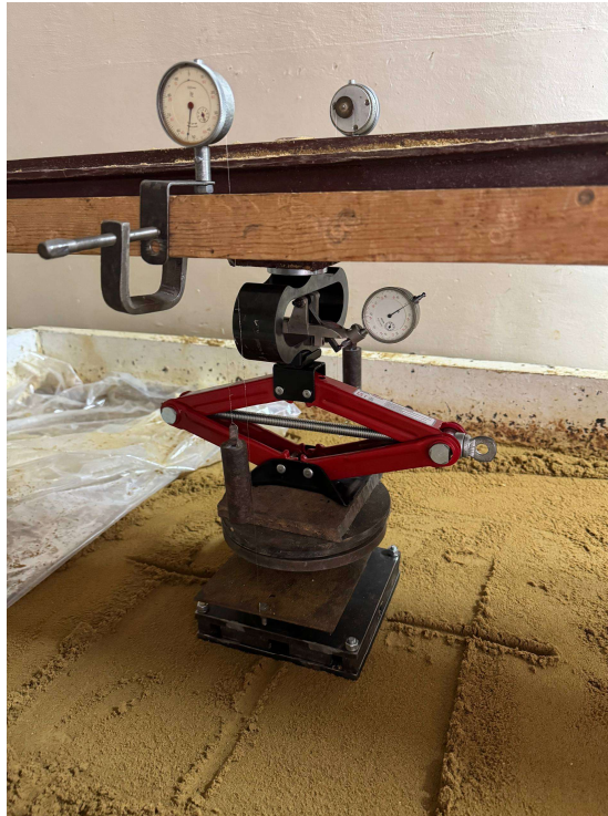
Рис. 9 – Система для передавання навантаження на модель ростверку (штамп) без паль
