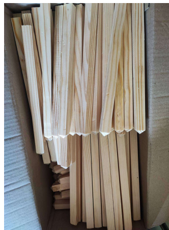
Рис. 1 – Дерев'яні моделі паль різної довжини
