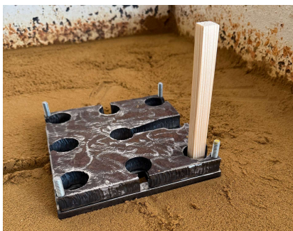
Рис. 7 – Процес занурення паль у отвори ростверка
