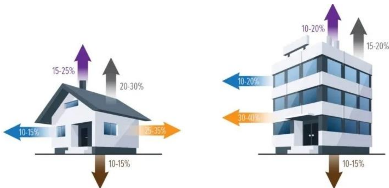
Рис. 1. Тепловтрати через конструкції будівлі
