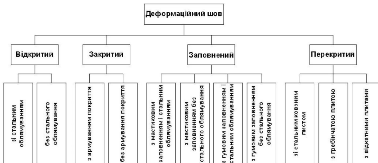
Рис. 1. Класифікація конструкцій деформаційних швів автодорожніх мостів [3]
