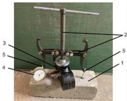
Рис. 2. Установка для статичного навантаження 1 –зразок; 2 –силовий механізм; 3 –динамометр; 4 –індикатор годинникового типу; 5 –клиновий анкер
