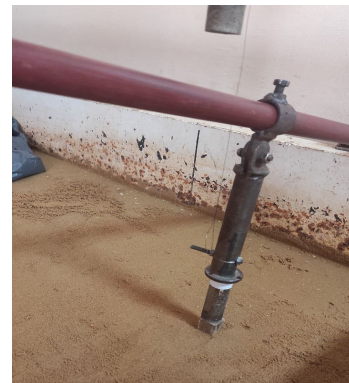
Рис. 11 – Модель випробування плити ростверку у варіанті умовного фундаменту
