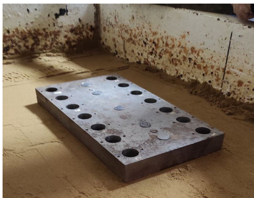
Рис. 4 – Експериментальна модель фундаменту
