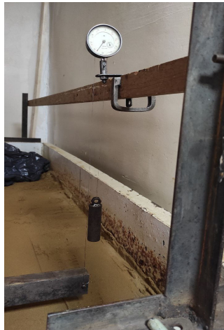
Рис. 6 – Система встановлення прогиноміру для досліду
