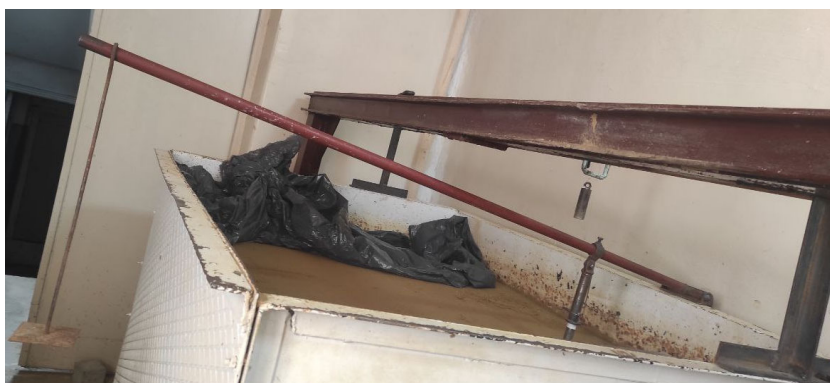
Рис. 12 – Модель випробування одиночної палі в лотку
