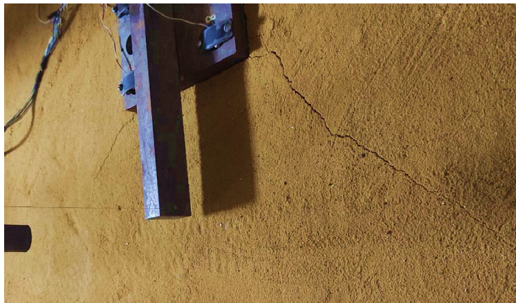
Рис. 14 – Приклад руйнування основи при випробуванні моделей паль довжиною 40 см з кроком 6d
