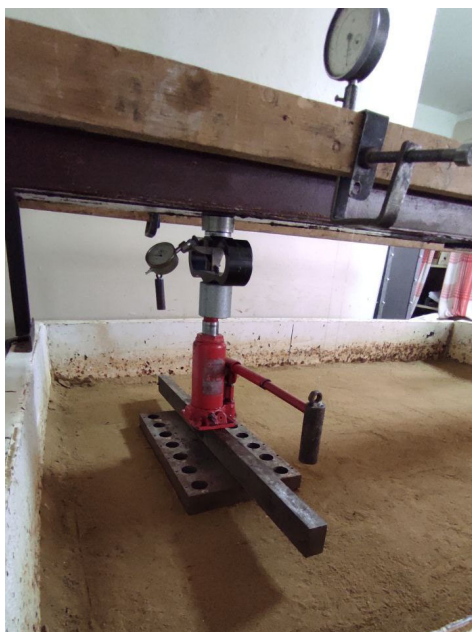
Рис. 10 – Модель випробування плити ростверку
