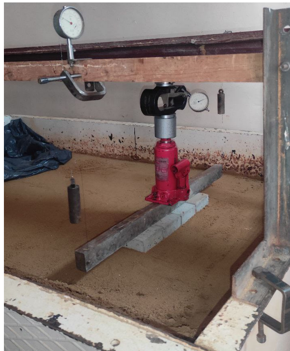
Рис. 11 – Модель випробування плити ростверку у варіанті умовного фундаменту
