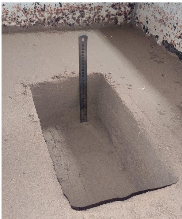
Рис. 11 – Модель випробування плити ростверку у варіанті умовного фундаменту
