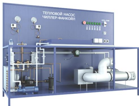
Рисунок 1 – Експериментальні стенди для дослідження характеристик теплового насосу «повітря-вода»: а) стенд з повітряно-водяним теплообмінником для відбирання теплоти; б) стенд з радіаторами відбирання теплоти
