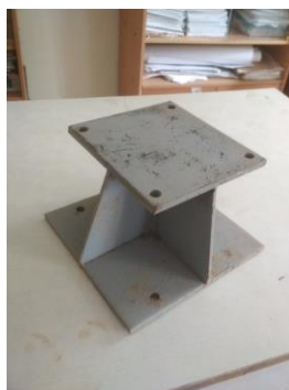
Рисунок 1 – Модель фундаменту мілкого закладання з розмірами підшви 230×245 мм
