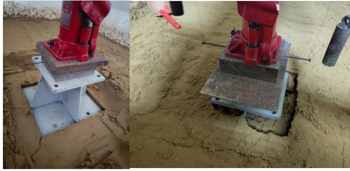
Рисунок 4 – Стан основи при втраті ґрунтом стійкості при глибинах закладання фундаменту 0, 1 та 0,5 b
