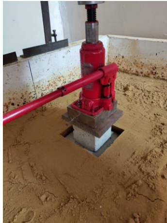
Рисунок 5 – Характер деформацій основи після втрати ґрунтом стійкості при глибині закладання 1,0b
