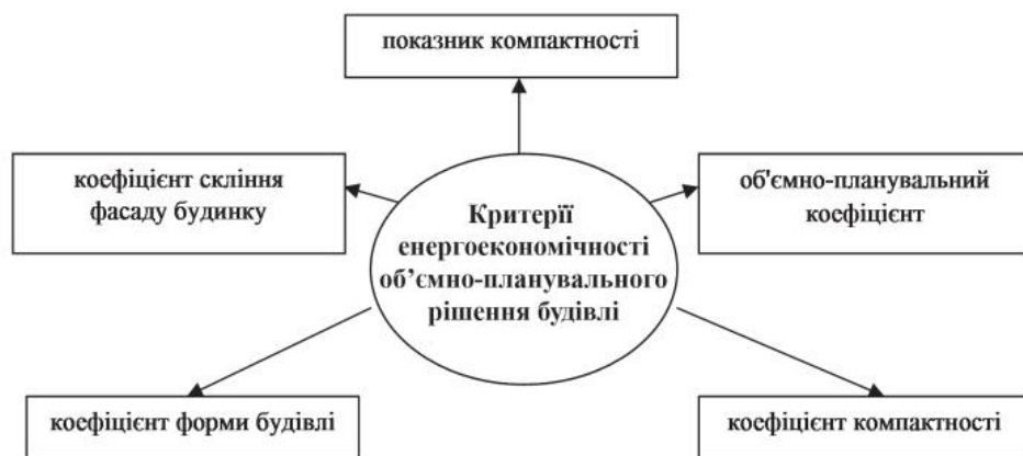
Рисунок 1 - Критерій енерго-економічності об'ємно-планувального рішення будівлі
