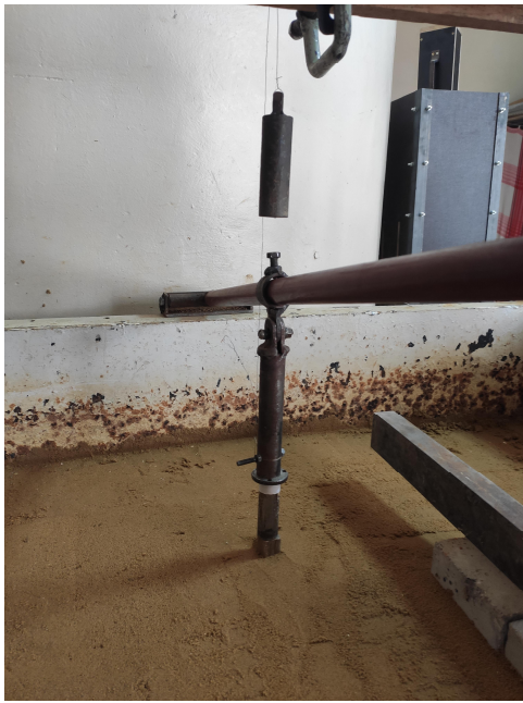
Рис. 10 – Модель випробування одиночної палі в лотку
