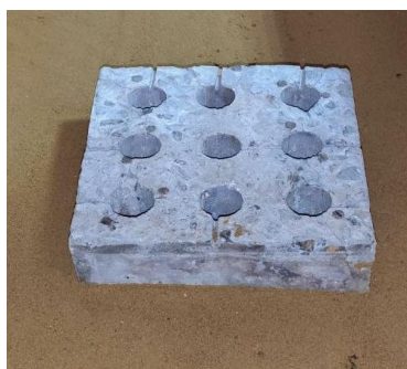
Рис. 1 – Модель ростверку 200х200 мм
