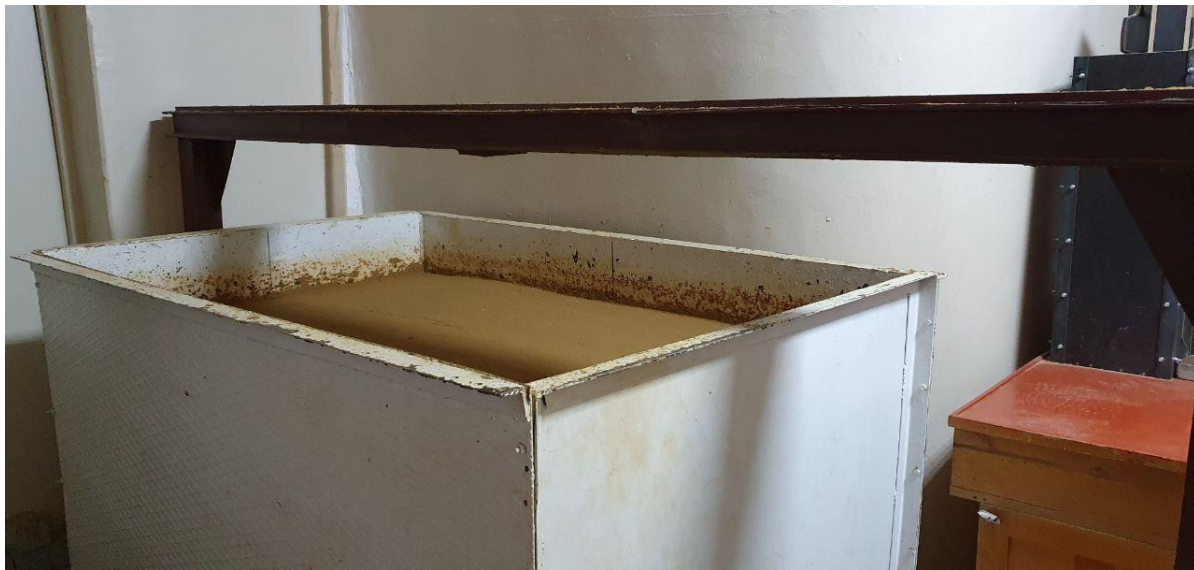
Рис. 2 - Лоток з ґрунтовою основою під фундамент
