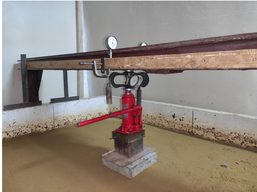
Рис. 8 – Модель випробування плити ростверку
