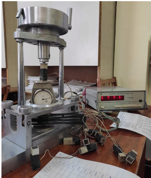
Рис. 4 – Пристрій для тарування датчиків
