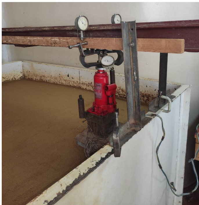
Рис. 7 – Модель пального фундаменту перед випробуванням
