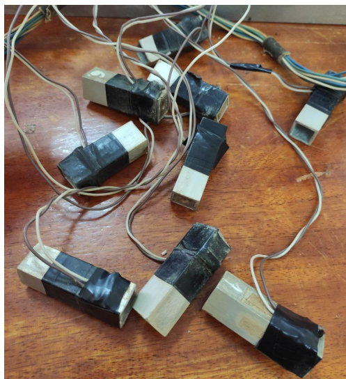
Рис. 3 – Наголовники із тензометричними датчиками
