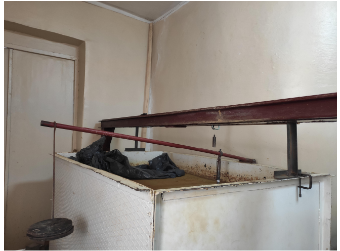
Рис. 10 – Модель випробування одиночної палі в лотку
