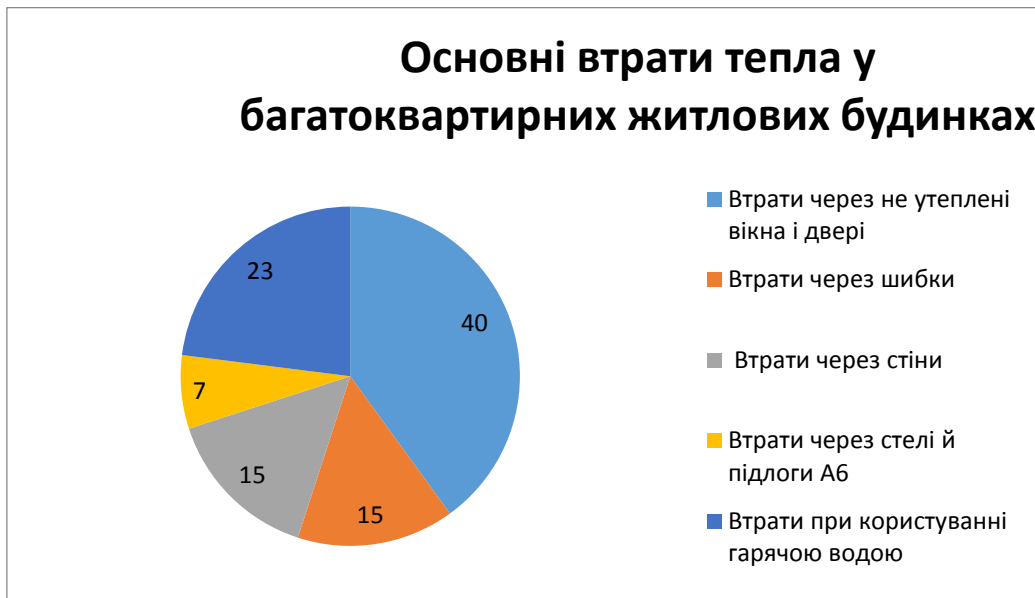
Рис. 1. Основні втрати тепла у багатоквартирних житлових будинках
