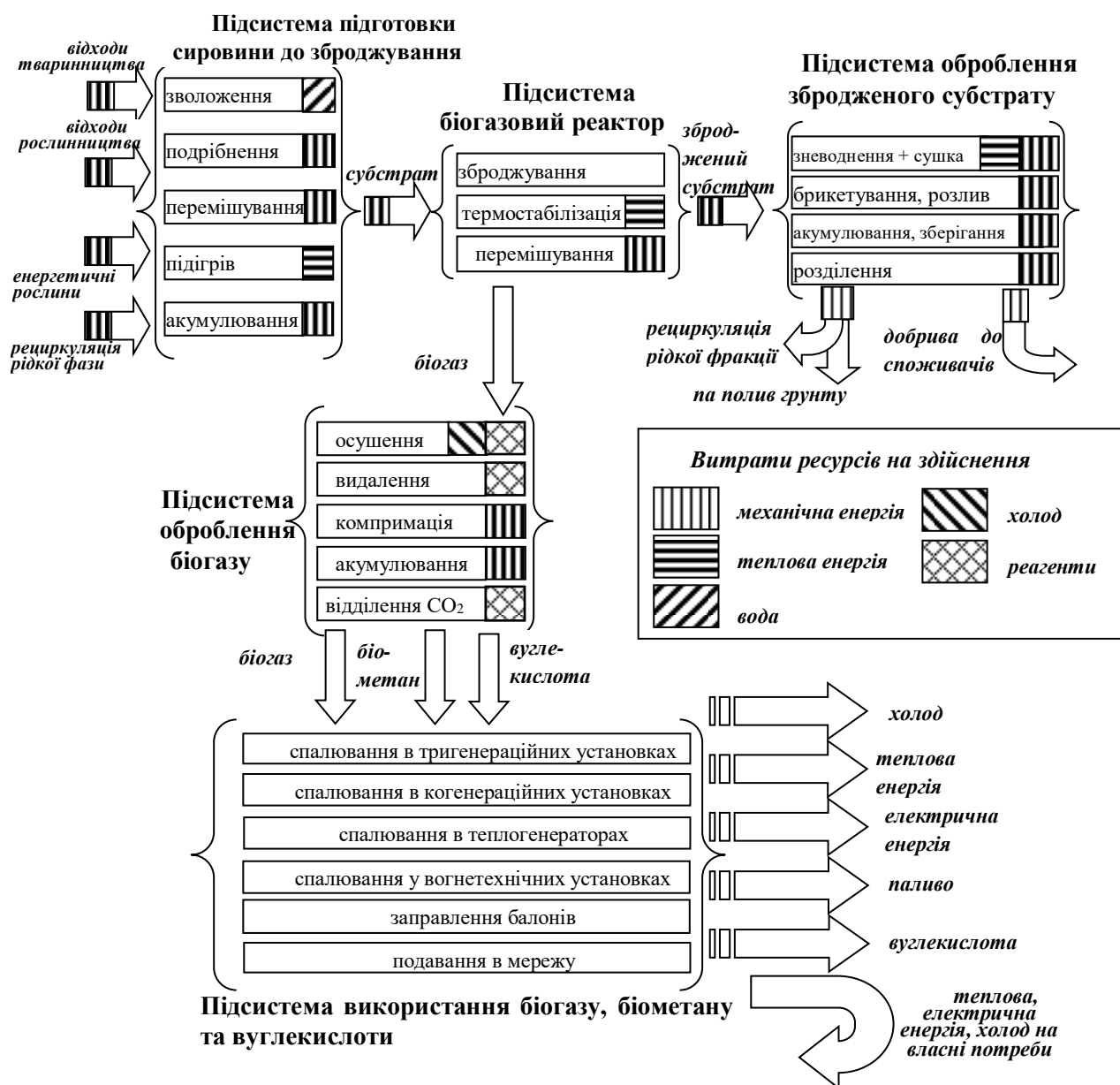
Рисунок 1 – Узагальнена функціональна схема біогазової технології
