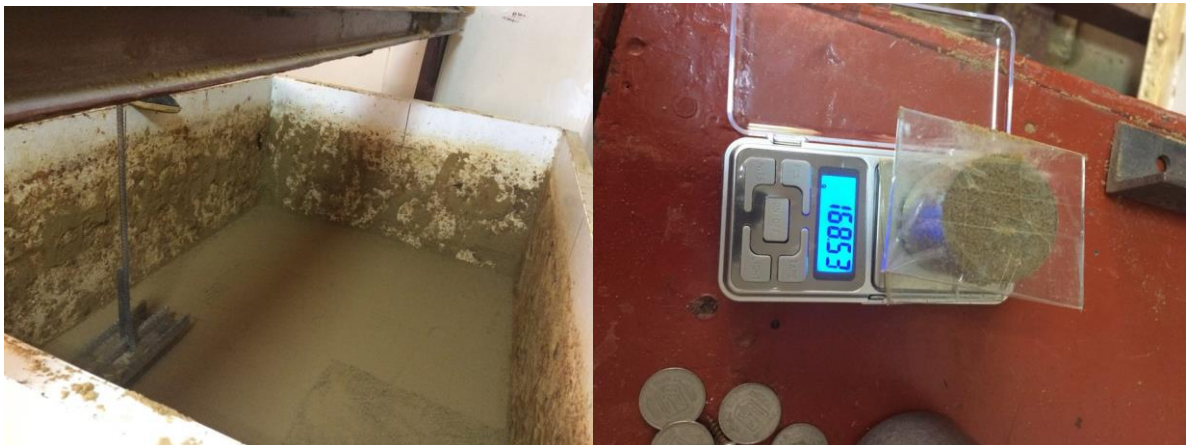
Рис. 2. Пошарове ущільнення піску та зняття проби щільності ґрунту
