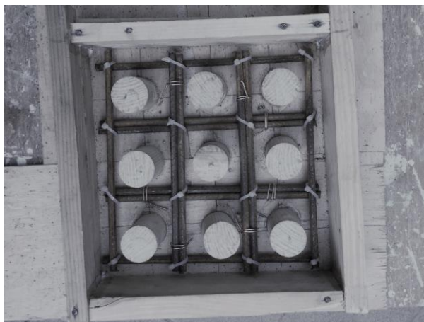
Рис. 1 – Опалубка і схема розташування арматури ростверку розмірами 200x200 мм
