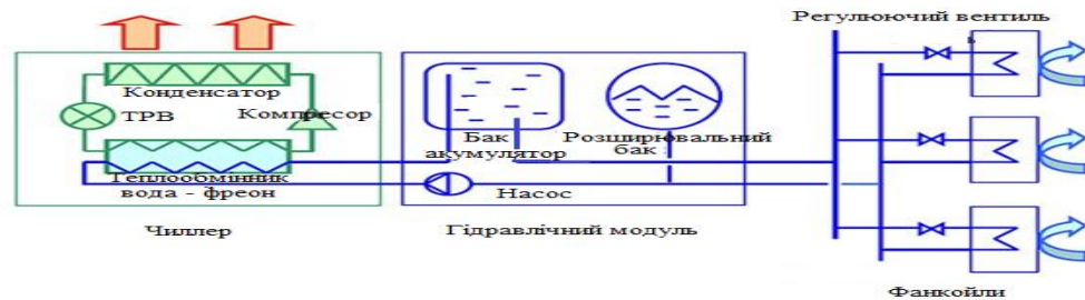
Рис.1 Принципова схема роботи системи «чиллер – фанкойл»
