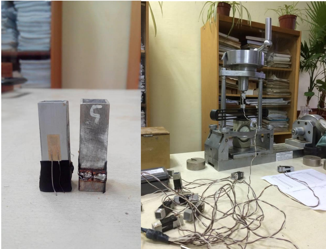
Рис. 1. Датчики напружень та тарування датчиків
